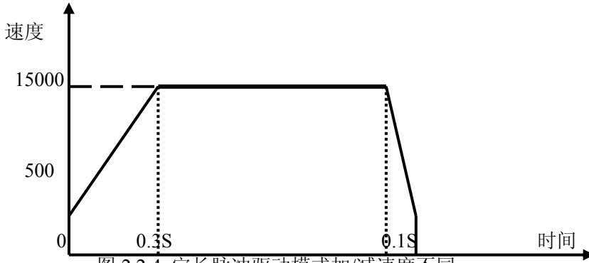
图 2.2.4 定长脉冲驱动模式加/减速度不同
